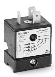
Les capteurs magnétiques Mod. CSN-2032-0 sont constitués d'un ampoule Reed avec protection et d'une diode rouge de visualisation, le tout recouvert d'un matériau étanche et isolant.
