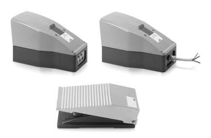
Les pédales sont disponibles en version pneumatique et électriques. Le modèle à commande pneumatique existe en 3/2 et 5/2 avec raccordement M5, Ø4 ou 1/4". La connexion pneumatique arrière facilite le montage des raccords et silencieux.
