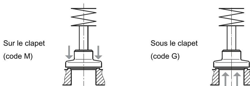
Sous le clapet est le sens du débit préconisé pour les fluides liquides incompressibles afin d'éviter les coups de bélier
