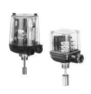
Les indicateurs électriques de position types GEMÜ 1214 et 1232 disposent d'un ou deux détecteurs de proximité pour l'indication des fins de course. Ces détecteurs de proximité sont réglables mécaniquement. L'indicateur GEMÜ 1214 est destiné au montage sur actionneurs linéaires dont la course peut aller jusqu'à 70 mm. L'indicateur GEMÜ 1232 est destiné au montage sur actionneurs linéaires dont la course peut aller jusqu'à 20 mm.
