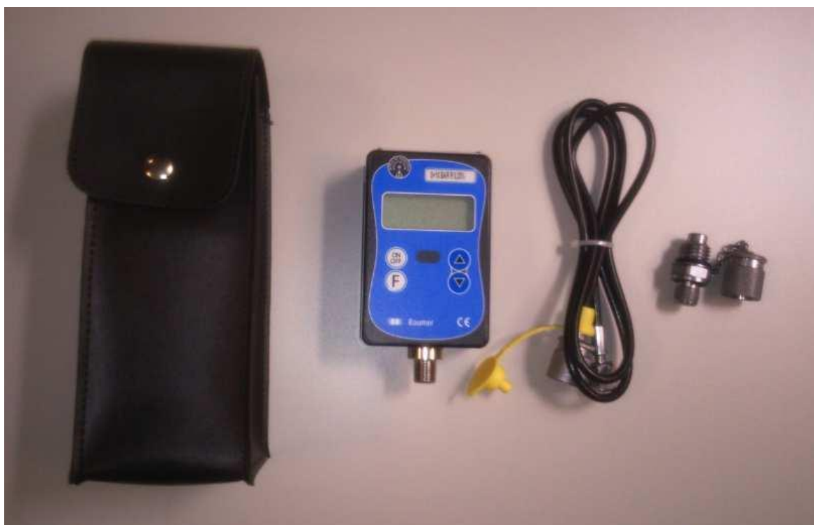
Portable EA- - P----- -XXXX (Livré avec avec flexible de 1 m M16x200, saccoche et raccord à clapet )
