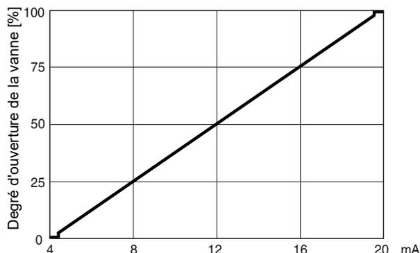
Le positionneur 1441 cPos-X détecte automatiquement, pendant l'initialisation, la fonction de commande de la vanne et s'ajuste en standard de telle sorte que la vanne se ferme à l'entrée de signal 4 mA\*.
