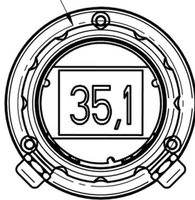
Montage mural FlexHousing Ø110 mm, bride arrière avec 3 trous x Ø4 mm pour vis
