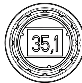
Montage sur panneau Ø110 mm, bride avant avec 3 trous x Ø4 mm pour vis
