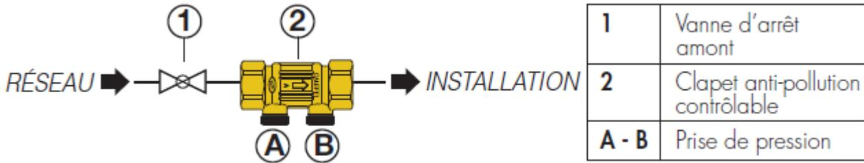
Avant d’installer le clapet anti-pollution, nettoyer la tuyauterie des impuretés à l’aide d’un jet d’eau de grand débit.
