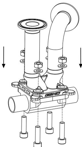
1. Monter l'adaptateur multifonction PPF sur le corps de vanne.
