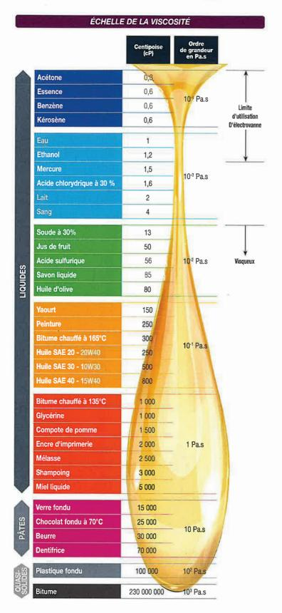
La viscosité dynamique d'un fluide caractérise l'ensemble des phénomène physiques s'opposant à son écoulement.
