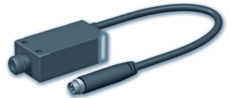
Le vacuostat électronique PSP100CX intègre en standard le réglage de seuil et d'hystérésis. Il est équipé de deux raccords au vide (G1/8"-Mâle, M5-Femelle) et d'un connecteur M8 4 pôles pour la connection électrique.
